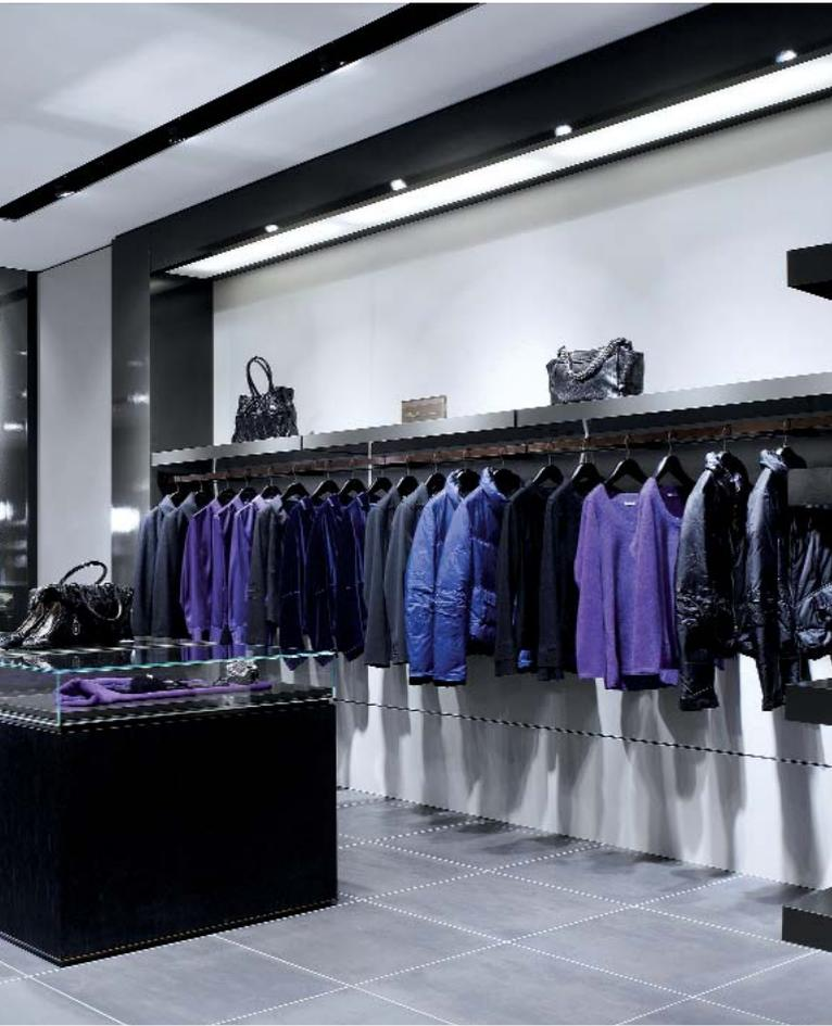
Im Mittelraum wurden Einputzleuchten eingesetzt, von denen keine Rahmen zu sehen sind. Schwarze Aufbaustrahler, in ebenfalls schwarze Deckenkanäle versenkt, tauchen die Wandzonen in ein effektvolles Licht. Die symmetrische Anordnung der Beleuchtungskörper unterstützt den edlen Charakter des Laden-Layouts.
