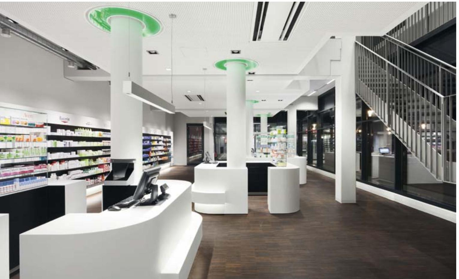
Jeder Counter wird über eine 45 cm dicke Rundsäule mit der Decke verbunden. In dieser Säule aus geformten, weiß beschichteten Holzwerkstoff, befindet sich versteckt die Fördertechnik des im Obergeschoß befindlichen Kommissionierers. Die Medikamente werden voll automatisch durch eine in der Säule montierte Förderrolle zur Ausgabenschütte auf den Tresen transportiert. Selbstleuchtende Taschenablagen
